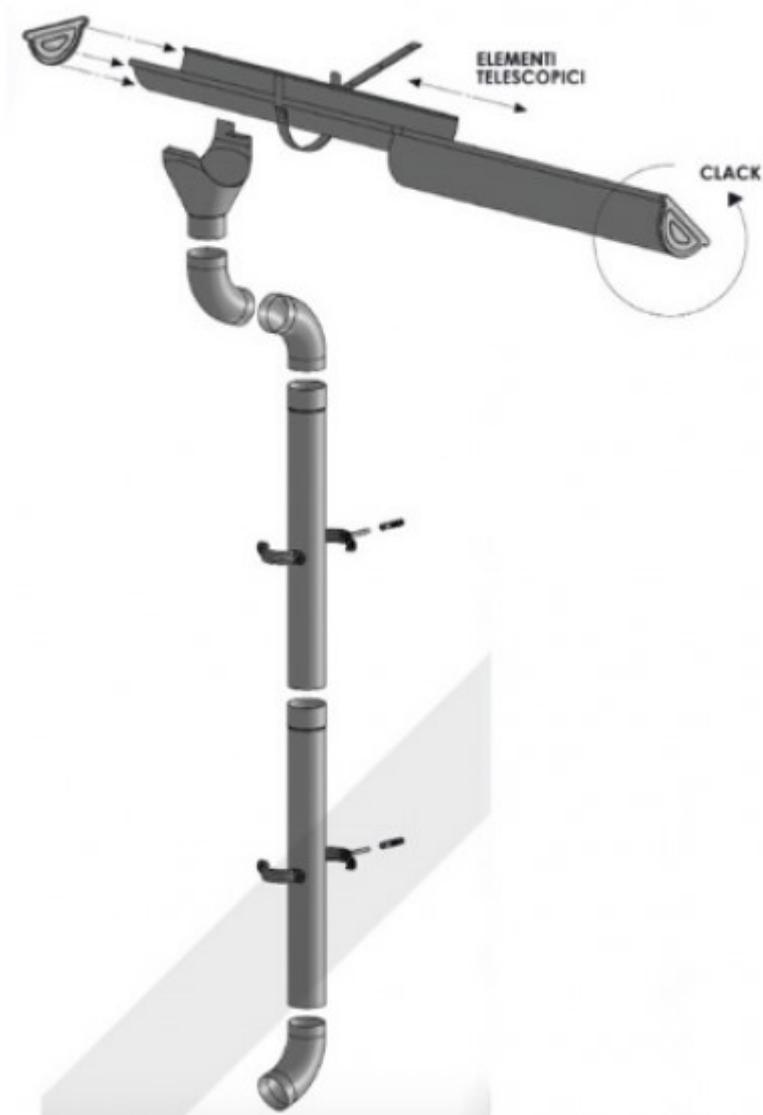
*Fig 1 : Canale di gronda e pluviale tipo*
